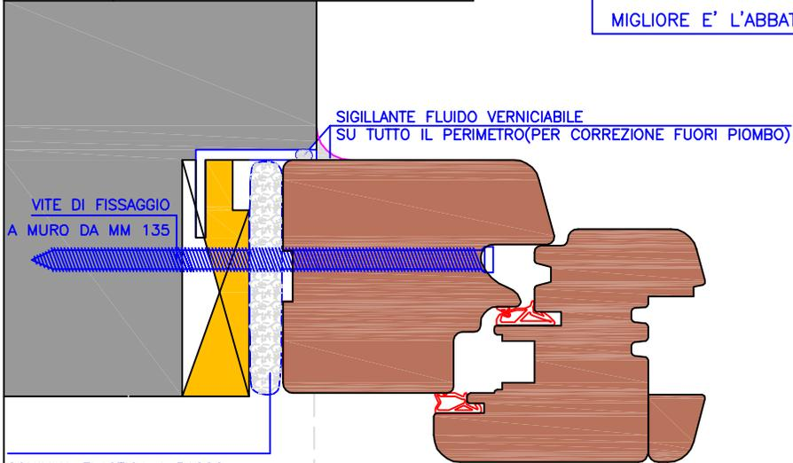
SCHIUMA ELASTICA A BASSO MODULO PER L'ISOLAMENTO TERMICO E ACUSTICO (ABBATTIMENTO NOMINALE 60 dB)
